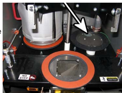
O sensor RTD está localizado à uma pol. abaixo da tela da estação de aquecimento (veja seta)
