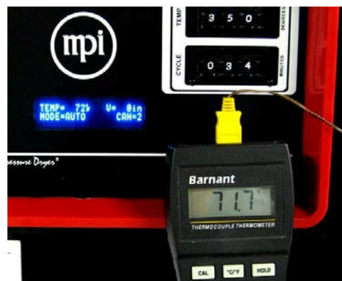
O sensor RTD está localizado à uma pol. abaixo da tela da estação de aquecimento (veja seta)
