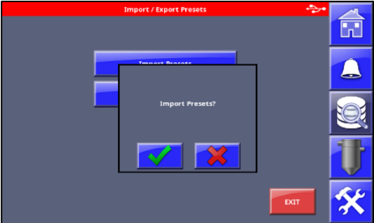
Conecte o USB com o novo material pré-ajustado adicionado ao arquivo .CSV e pressione o botão 'Import Presets' (Importar pré-ajustes).
